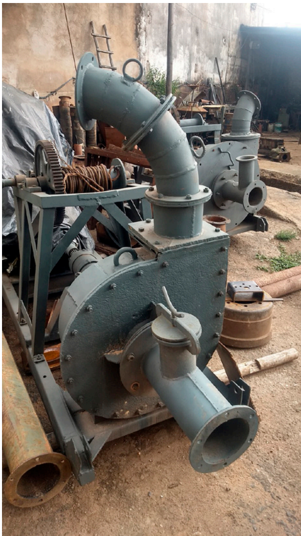
Figura 6: Manutenção e reforma de bombas de sucção. Fonte: Foto dos autores, 2019.
