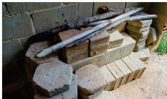
Blocos de cimento feitos pelo Sr. Sérvulo. Fonte: Acervo Gesta, 2017.
