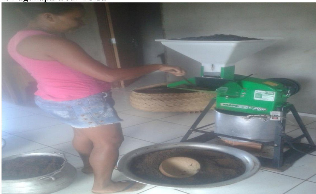
Figura 12 – Quebradeira de coco coloca a amêndoa do babaçu na forrageira para ser moída
